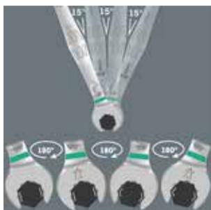
借助翻转角为 7.5°的开口和双六角几何形状, 当扳手用法恰当时 (准备- 紧固- 旋转- 再度准备- 紧固- 旋转), 可拧动摆动幅度不超过30°的螺丝。
