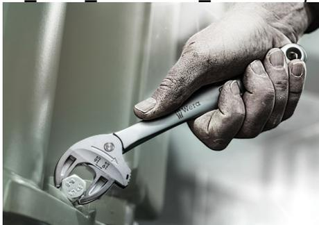
La clé à fourche auto-ajustable Joker 6004 s'ajuste à la taille nécessaire sans paliers automatiquement au contact des vis ou des écrous hexagonaux. L'utilisation des prismes dans la partie avant de la fourche permet un angle de reprise de seulement 30° pour travailler dans les espaces très réduits.
