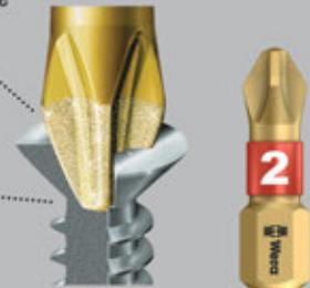
Puntas con partículas diminutas de diamante en sus extremos. Estas partículas proporcionan un alojamiento seguro dentro del tornillo, reducen la presión de prensado necesaria, y disminuyen el riesgo de que la herramienta se resbale del tornillo.
