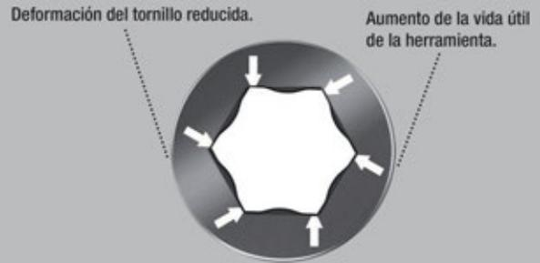
Puntas resistentes y duras para tornillos de hexágono interior, para aplicaciones universales. El perfil Hex-Plus ofrece mayores superficies de apoyo en la cabeza del tornillo. De esta forma, el efecto de entalladura se reduce a un mínimo, y la destrucción de la cabeza del tornillo se evita casi por completo.
