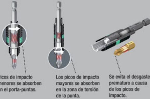
Puntas BiTorsion para tornillos hexagonales con zona de torsión a la cual se deriva energía cinética en el caso de picos de carga. De esta forma se consigue un aumento significativo de la vida útil del producto.
